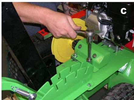
Spannen des Motors aufspannen. Dabei gleichzeitig Parallelität der Riemenscheiben beachten – Abb. D.
