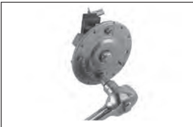
Abbildung 8-59. Abnahme der Bürstenhalterung.
