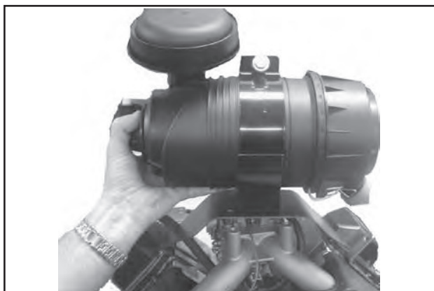
Abbildung 9-14. Abnahme des Hochleistungsluftfilters (Darstellung zweizylindriges Modell).
