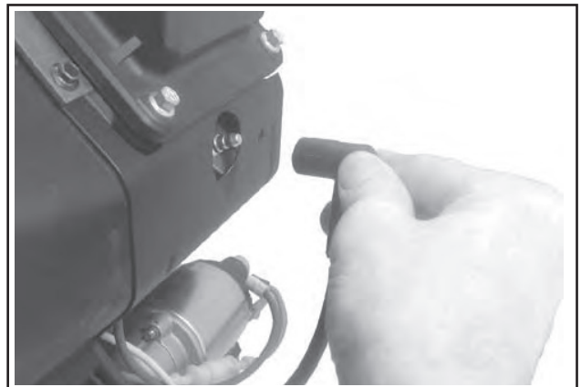
Abbildung 9-1. Beide Zündkerzenkabel trennen.
