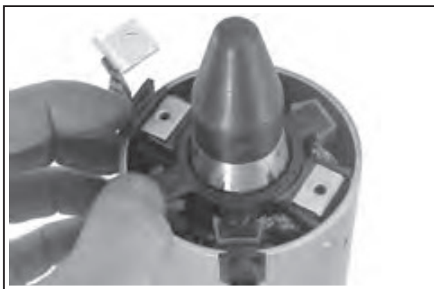
Abbildung 8-70. Installation Bürstenhalterungseinheit mit Werkzeug mit Verlängerung.
