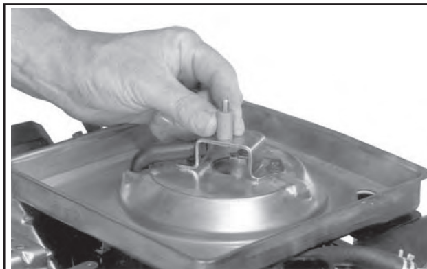
Abbildung 9-8. Abnahme der Halterung des Luftfiltersockels.
