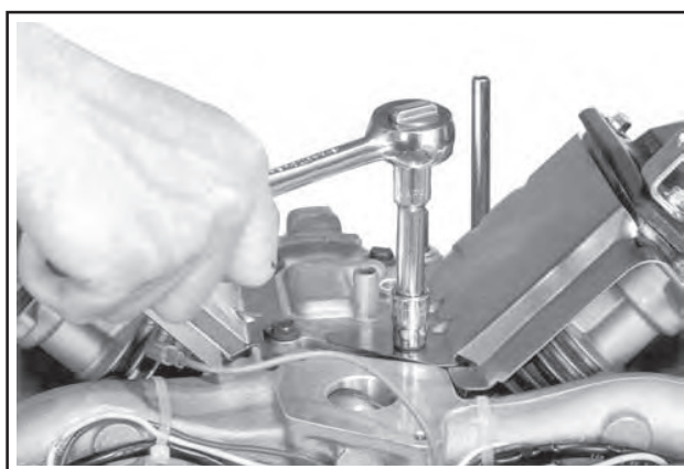
Abbildung 9-39. Entfernung der Befestigungsanschlüsse des Entlüfterdeckels und des Blechs.
