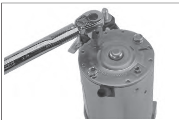
Abbildung 8-72. Anzug Schrauben Bürstenhalterung.
