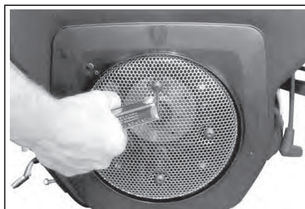
Abbildung 9-36. Abnahme des Metall-Grasschutzes.
