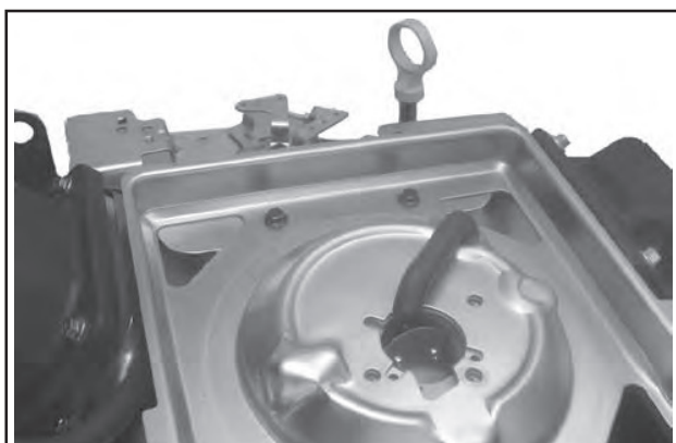
Abbildung 9-9. Schrauben der hinteren Halterung des Luftfilters.
