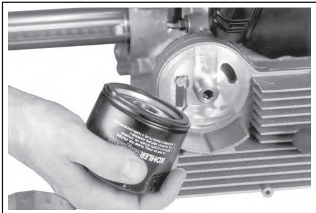
Abbildung 11-101. Installation des neuen Ölfilters.
