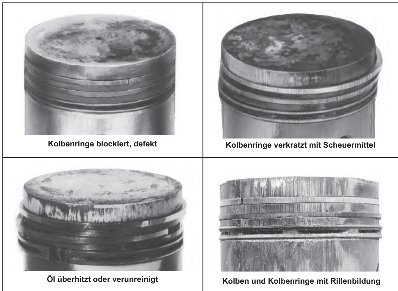
Abbildung 10-8. Häufige Kolbensschäden.
