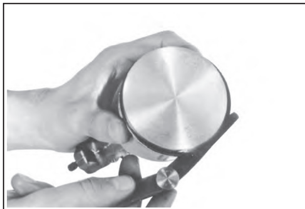
Abbildung 10-10. Messung des Seitenspiels der Kolbenringe.
