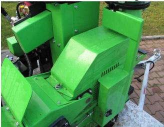
**Der Raum der kippbaren Hauben** wird mit einem Endschalter geschützt. Ist die Haube nicht richtig verriegelt, kann der Motor nicht gestartet werden. Die abgebildete Haube schützt den Raum des Abzugsrohrs und der Zerkleinerungsscheibe.
