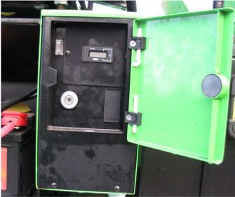
**Der Zündschlüssel des Schaltkastens** zum Motorstarten ist herausnehmbar. Eine Vertauschung der Zündschlüssel ist nicht möglich. Zum Start den Schlüssel in die Stellung START drehen. Der Motor läuft weiter in der Stellung RUN. Dieser Schaltkasten ermöglicht nicht einen neuen Start aus der Stellung RUN, bzw. man muss erst den Schlüssel zurück in die Stellung OFF drehen.
