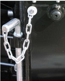
**Der Sicherungsbolzen der Zerkleinerungseinrichtung** dient zur Arretierung des Rotors bei Wartung, bzw. Messerwechsel, usw. Das eigene Sichern erfolgt nach Öffnen der Haube des Zerkleinerungsraums durch Einlegen des Bolzens in einer der Löcher  $\varnothing 50$  an der Wand des Rotors, siehe Abb.
