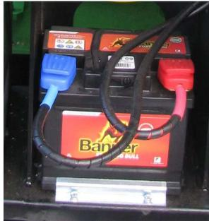
**Die Batteriekontakte** sind mit Schnellkonnektoren ausgestattet.
