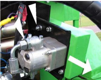
Die hydraulische Pumpe wird mithilfe von einem Keilriemen von dem Antriebsmotor angetrieben. Zum Aufspannen des Keilriemens erst den Deckel (zwei Schrauben M6 nebenan der Pumpe) entfernen. Unter dem Deckel gibt es zwei Befestigungsschrauben M10 (siehe Pfeil in Abb.) und eine Spannschraube M8 zur Nachspannung des Riemens.
