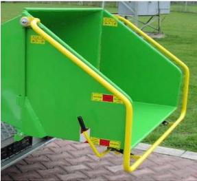
**Der Sicherheitsrahmen zum Einlegen des Materials** dient als eine Laufbetätigung, zum Stoppen und Reversierung der Einlegewalzen. Durch Drücken auf die Rahmenkante (bei gefährlicher Situation bzw. zur Reversierung des Walzenlaufs) wird die Bewegung der Walzen unverzüglich gestoppt und bei weiterem Druck hinter die Kante der Einlegerutsche kommt es zur Reversierung des Walzenlaufs.
