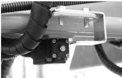
**Der Endschalter** des abklappbaren Teils der Einlegerutsche schaltet den Antriebsmotor bei Abklappen der Rutsche ab.
