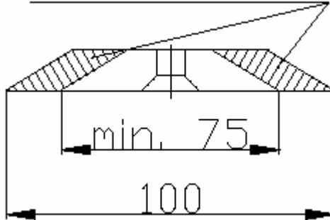
Max. Verschleiß/Schleifen der Messerschneide
