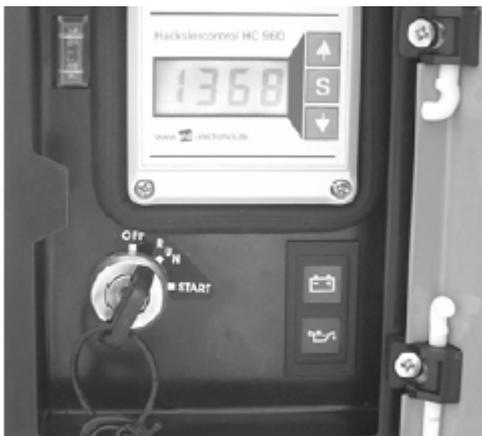
**Der Zündschlüssel des Schaltkastens** zum Motorstarten ist herausnehmbar. Eine Vertauschung der Zündschlüssel ist nicht möglich. Zum Start den Schlüssel in die Stellung START drehen. Der Motor läuft weiter in der Stellung RUN. Dieser Schaltkasten ermöglicht nicht einen neuen Start aus der Stellung RUN, bzw. man muss erst den Schlüssel zurück in die Stellung OFF drehen.
