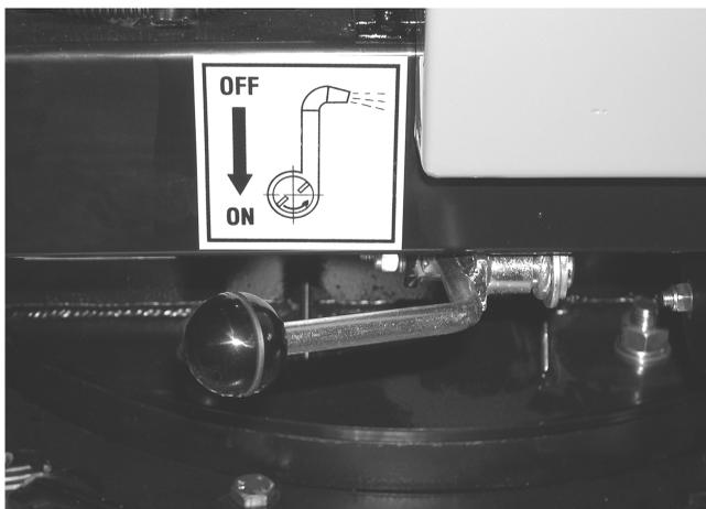
Betätigungshebel zum Spannen der Keilriemen
