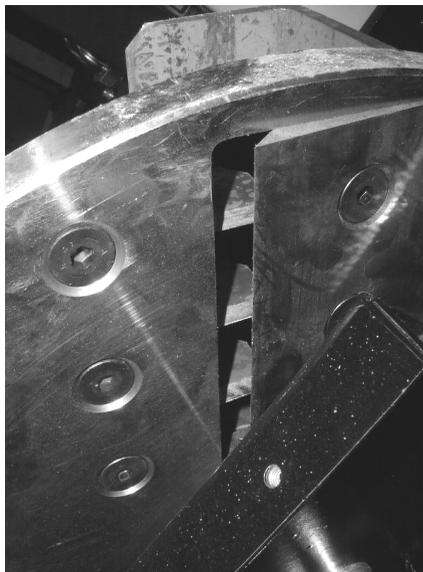
Eine Darstellung des eingebauten Brechers. Der Brecher ist an der Auslauföffnung von dem Messer eingebaut und dient zum Brechen der quer abgeschnittenen Holzscheiben.
