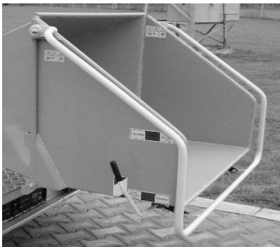
**Der Sicherheitsrahmen zum Einlegen des Materials** dient als eine Laufbetätigung der Einlegewalzen, zum Stoppen und Reversierung.
