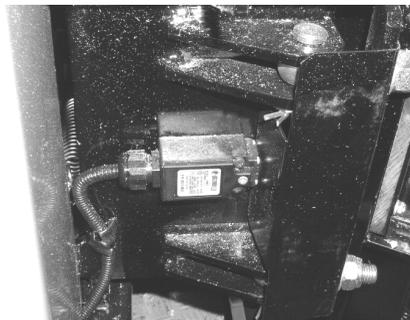
**Die Sicherheitshaube des Einlegeraums** mit einem Endschalter sichert den Raum hinter den Walzen gegen etwaiges Öffnen und schützt dadurch den Bedienenden
