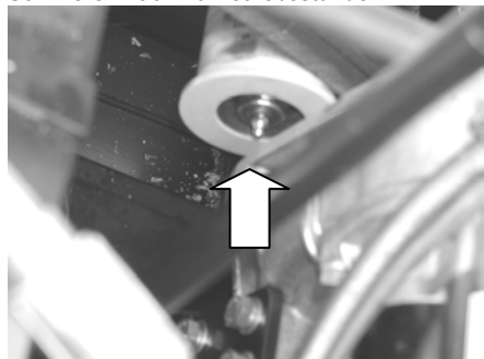
Schmierbüchse der Spannrolle Schmieren nach 40 Betriebsstunden
