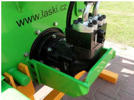
**Der Hydromotor wird von einem Ventilblock gegen Überlastung (beim plötzlichen Stoppen) geschützt.**
