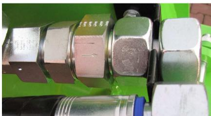
In der Ölrückleitung der Fräse ist ein Rückschlagventil eingebaut, das die Frässscheibe gegen Reversierung schützt.
