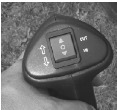
Taste zur Fernbedienung der Wickelwinde OUT – Seilabwicklung IN – Seilaufwicklung
