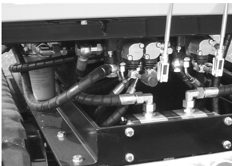
Betätigungshebel zur Abstandseinstellung der Raupenbänder
