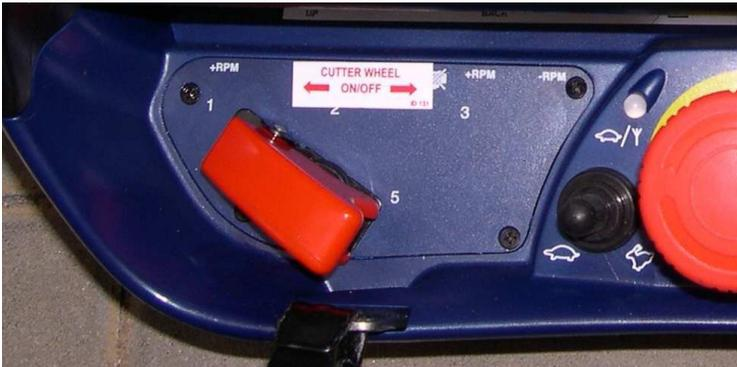
Abb. 12 – Der Schalter mit Schutzkappe zum Ingangsetzen der Frässscheibe
