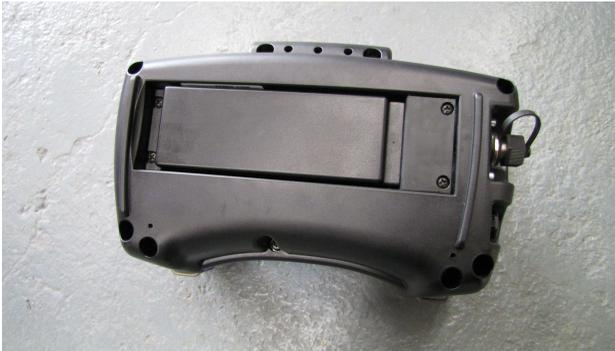
Abb. 57 – Batterie der Fernbedienung
