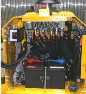
Abb. 13 – Batterieraum mit der unter der hinteren Haube oben mit Not-Aus-Taster
