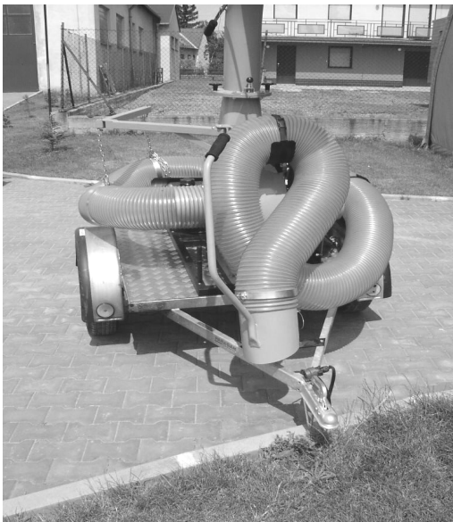
Saugleitung in Transportstellung
