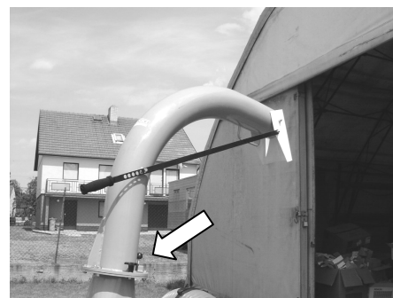
Sicherung des Endstücks gegen Drehen
