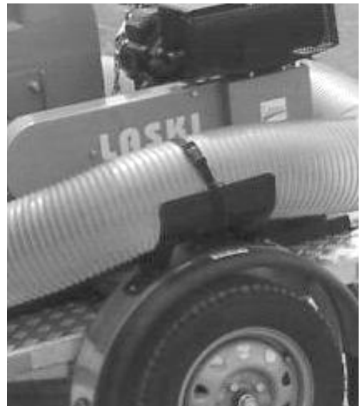
Sicherung der Saugleitung mit Befestigungsband
