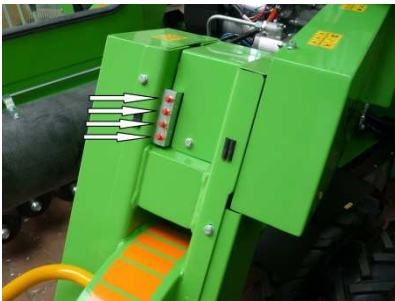
Schmierbüchsen an der Lagerung der Frässcheibe Schmieren immer nach 100 Betriebsstunden (wöchentlich)
