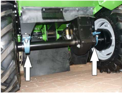
Schmierbüchsen an der Hinterachse Schmieren immer nach 500 Betriebsstunden
