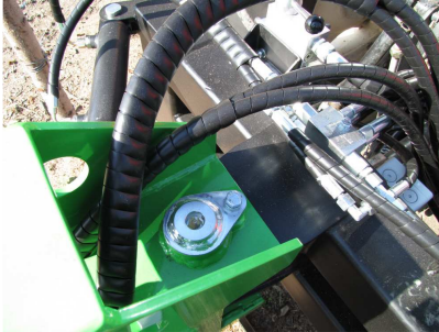
Schmierbüchse der Lagerung des Auslegers Schmieren nach 50 Betriebsstunden
