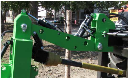
Schmierbüchse der Lagerung an der Aufhängung der Frässscheibe Schmieren nach 50 Betriebsstunden
