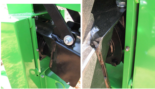
Schmierbüchsen der Lagerung des Riementriebs - Seitenwand an der Aufhängung der Frässscheibe - oben Schmieren nach 50 Betriebsstunden.
