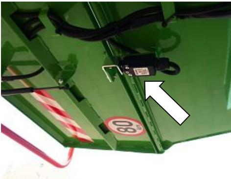
Die klappbare Sicherheitshaube des Einlegeraums mit einem Endschalter dient zum Blocken der Walzen bzw. des Motors gegen unerwünschten Start, falls die Haube verriegelt (zugeklappt) bleibt
