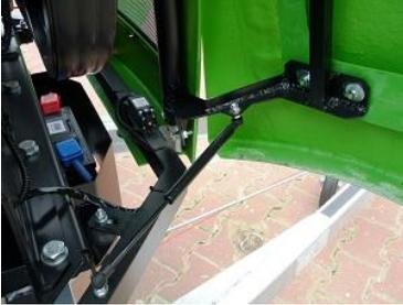
Der gefährliche Raum des Verbrennungsmotors und der Zerkleinerungsscheibe wird von einer Haube mit einem Endschalter geschützt. Ist die Haube nicht richtig verriegelt, kann der Motor nicht gestartet werden.
