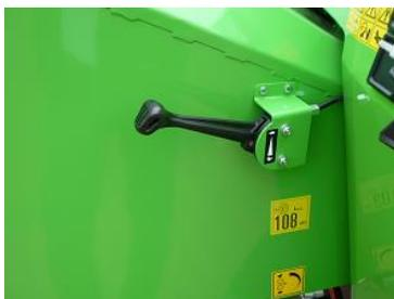
Der Betätigungshebel zur Drehzahlregelung des Motors
