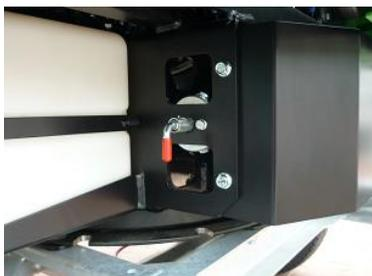
Der Abschalter dient zum Zuschalten der Batterie vor Inbetriebnahme der Maschine. Er ist oberhalb der Drehbühne angebracht.
