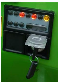
**Der Schaltkasten** mit einem herausnehmbaren Zündschlüssel zum Motorstarten. Jedwede Vertauschung der Zündschlüssel ist nicht möglich. Zum Start den Schlüssel in die Stellung START drehen. Der Motor läuft weiter
