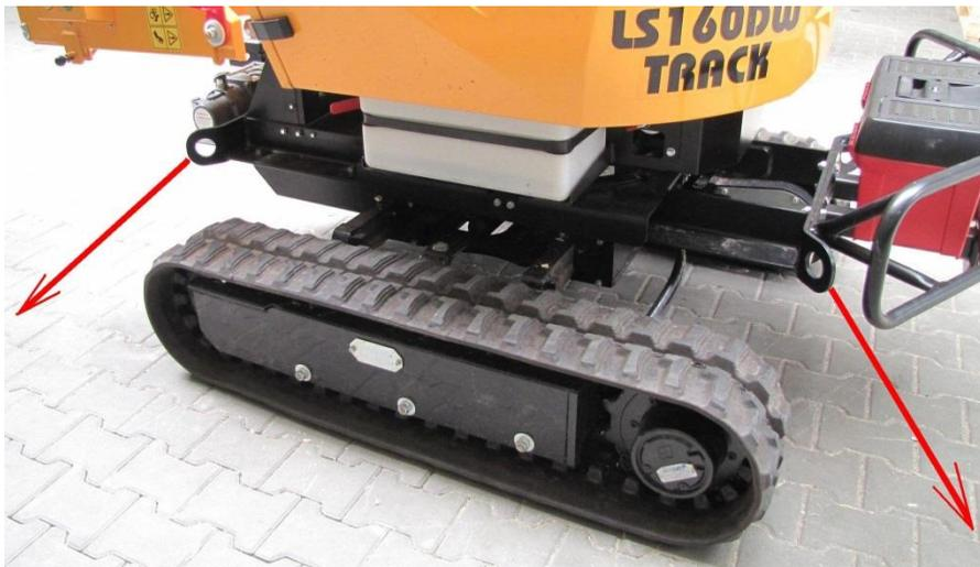
Befestigung der Halteketten an den Zurrösen des Motorrahmens
