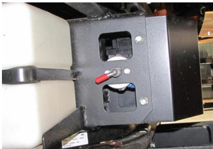
**Der Batterietrennschalter** ist mit einem Drehschalter versehen, der zum Abtrennen der Batterie bei Störung oder im Notfall. Den Trennschalter nie während der Arbeit der Maschine verwenden.
