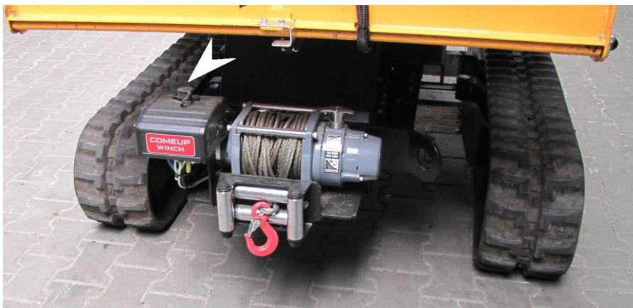
Die Seilwinde ist zur Bergung der Maschine bei etwaiger Einsenkung im nicht tragenden Gelände bei Überfahrt bestimmt. Diese Winde wird durch eine separate Fernbedienungseinheit betätigt, die in dem Klemmkasten (siehe Pfeil) angeschlossen ist.
