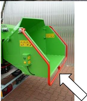
**Der Sicherheitsrahmen** zum Einlegen des Materials dient als eine Laufbetätigung bzw. zum Stoppen der Einlegewalzen. Durch Drücken auf die Rahmenkante bei gefährlicher Situation wird die Bewegung der Walzen unverzüglich gestoppt..
