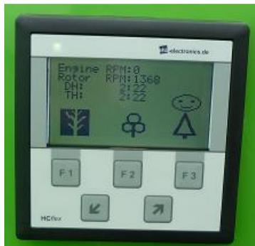
Das NOSTRESS-System dient als Schutz gegen Überlastung des Verbrennungsmotors. Es besteht aus einer elektronischen Steuereinheit und einem an der Rotorwelle installierten Drehzahlgeber.
