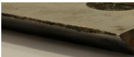
Das Messer an einer Seite ungleichmäßig abgenutzt. Max. Verschleiß (Materialschwund) darf nur 0,5 mm betragen. Seine weitere Abnutzung führt zum unerwünschten Radius an der Schneide und nachfolgend zu mechanischen Stößen bei weiterem Einsatz der Maschine.
