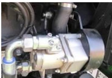
Die hydraulische Pumpe wird durch einen Riementrieb des Motors angetrieben. Zur Kontrolle der Riemen Spannung erst die seitliche Haube entfernen. Das eigene Nachspannen des Riementriebs erfolgt durch
