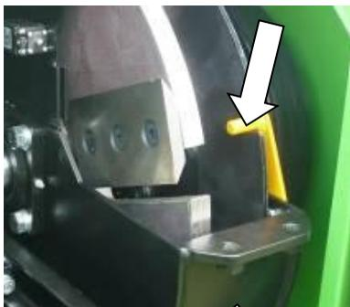
**Der Sicherungsbolzen der Zerkleinerungseinrichtung** dient zur Arretierung des Rotors bei Wartung, bzw. beim Messerwechsel. Der schwingende Bolzen ist am Kasten des Rotors angebracht. Die eigene Sicherung erfolgt durch Einlegen des Bolzens in die betreffende Kerbe am Rotorumfang.
