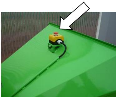
STOP-Taste – stopps gefährliche Bewegung der Einlegewalzen und schaltet der Antriebsmotor aus.
