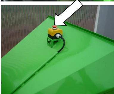
**Die Nottaste** – durch Drücken dieser Taste kommt es zum unverzüglichen Stoppen des Motors und damit aller Bewegungen der Maschine.
