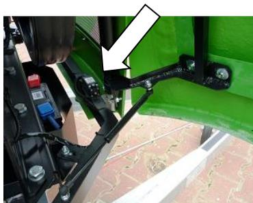
Der gefährliche Raum des Verbrennungsmotors und der Zerkleinerungsscheibe wird von einer Haube mit einem Endschalter geschützt. Ist die Haube nicht richtig verriegelt, kann der Motor nicht gestartet werden. Der installierte Endschalter schützt den
