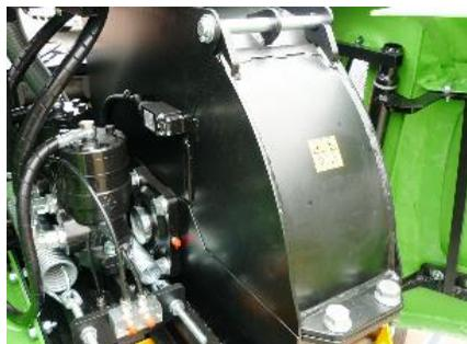
**Die Sicherheitshaube des Einlegeraums** mit einem Endschalter sichert den Raum hinter den Walzen gegen etwaiges Öffnen und schützt dadurch den Bedienenden gegen unerwünschten Start des Motors bei entdecktem Raum. Die Befestigungsschrauben der Haube müssen immer ordentlich angezogen sein.
