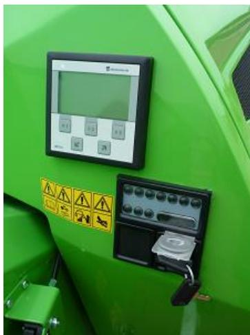
**Der Schaltkasten** – dient zur Einspeisung und Betätigung der Schutzstromkreise und des Motors.
