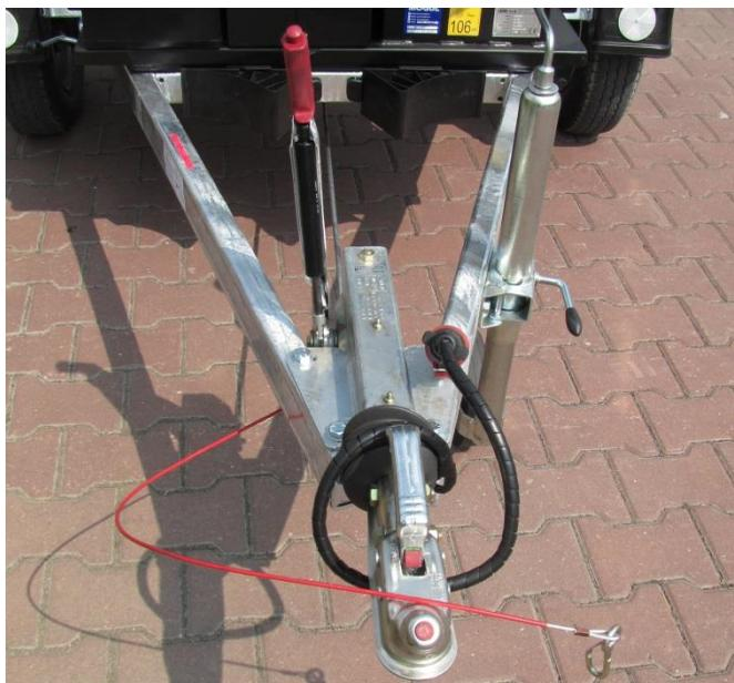
Zur Bemerkung: Die Maschinen in der Ausführung LS 160 DWB sind auch mit der Feststellbremse und der Sicherheitslitze ausgerüstet.
