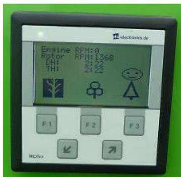
Das NOSTRESS-System dient als Schutz gegen Überlastung des Verbrennungsmotors. Es besteht aus einer elektronischen Steuereinheit und einem an der Rotorwelle installierten Drehzahlgeber.
