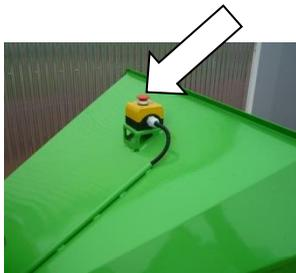
**Die Nottaste** – durch Drücken dieser Taste kommt es zum unverzüglichen Stoppen des Motors und damit aller Bewegungen der Maschine.
