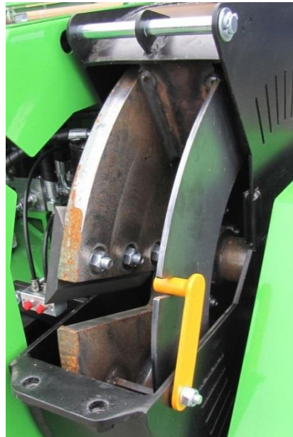
Der Sicherungsbolzen der Zerkleinerungseinrichtung dient zur
