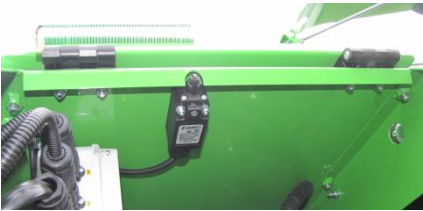
Der Raum an der Zerkleinerungsscheibe wird mit einem Endschalter geschützt.
