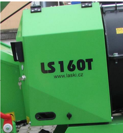
Der Raum an der Zerkleinerungsscheibe wird mit einem Endschalter geschützt.
