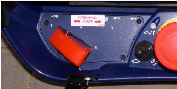
Abb. 12 - Rote Schutzkappe des Schalters zum Ingangsetzen der Frässscheibe
