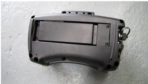
Abb. 57 – Batterie der Fernbedienung
