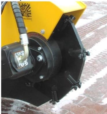
Abb. 20 – Sägeblatt Multi-Tip
