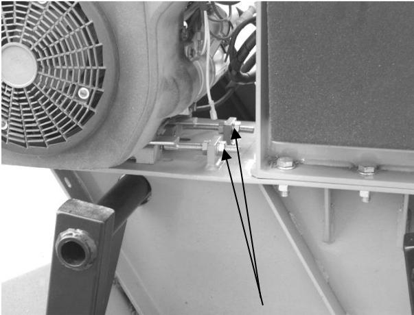
Spannschrauben des Riementriebs
