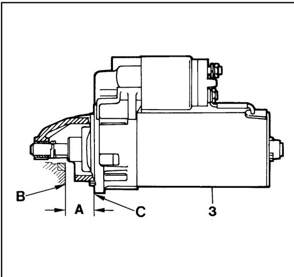
**3) Starting motor type Bosch DW (R) 12 V, 1.7 kW**
