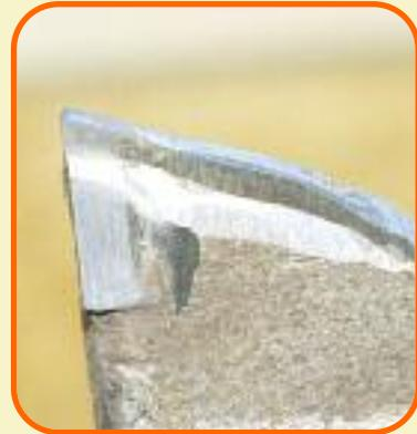
Wenn Sie das Hartmetallplättchen so geschliffen haben, dass eine saubere Schneidkante dabei herauskommt ist die Hauptarbeit getan. Sie können dann das Fräsmesser von der Rückseite noch etwas „beischleifen“, dass der Übergang zwischen Hartmetallplättche und Schmiedeteil einen gleichmäßigen Freiwinkel hat. Das Ergebnis sollte dann so, wie auf dem Bild rechts aussehen. Hierzu ist die Schruppscheibe zu benutzen.
